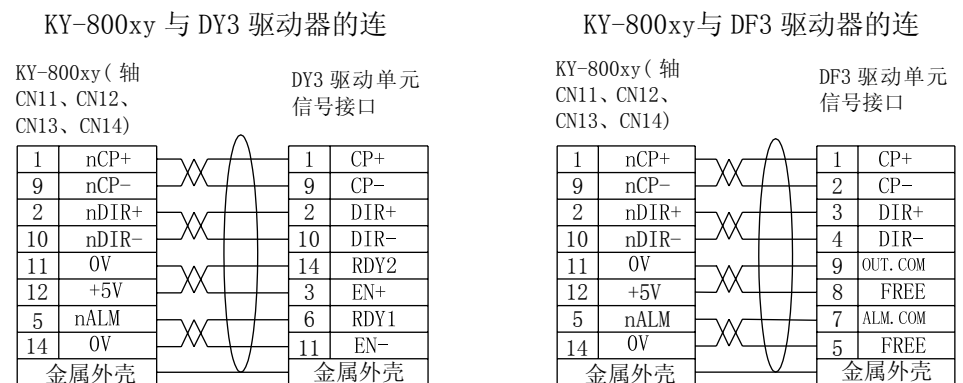
图 2-11 KY-800xy 与驱动单元的连接
